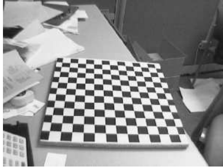
Figure 6: Un objet de calibration très largement utilisé : le damier. Les sommets constituent en effet des primitives qui sont facilement détectables dans les images, et dont les positions dans la scène sont connues.
