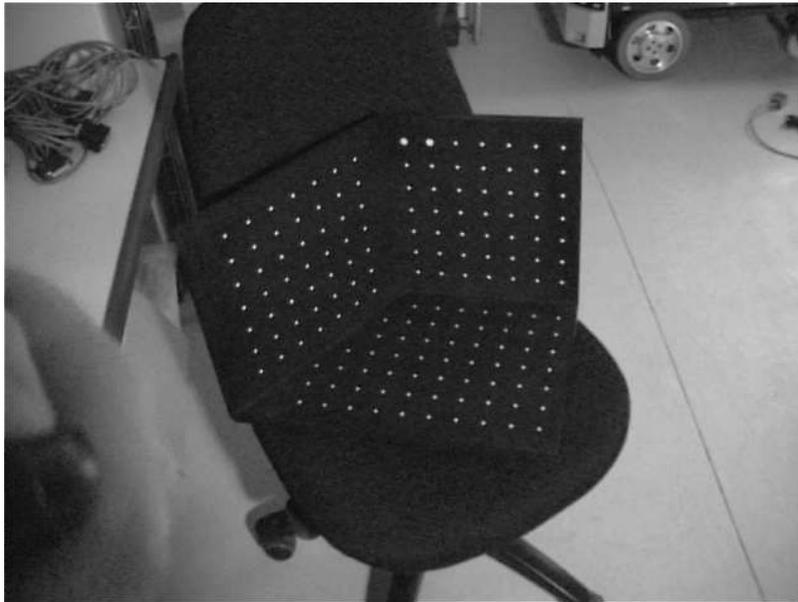
FIG. 3 – La mire de calibrage utilisée dans le projet MOVI.
