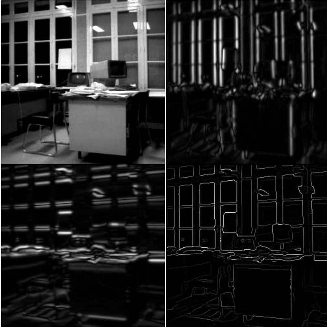
Figure 1: (a) : image originale, (b) : gradient en x (filtre de Deriche), (c) gradient en y (filtre de Deriche), (d) extréma locaux de la norme du gradient dans la direction du gradient.
